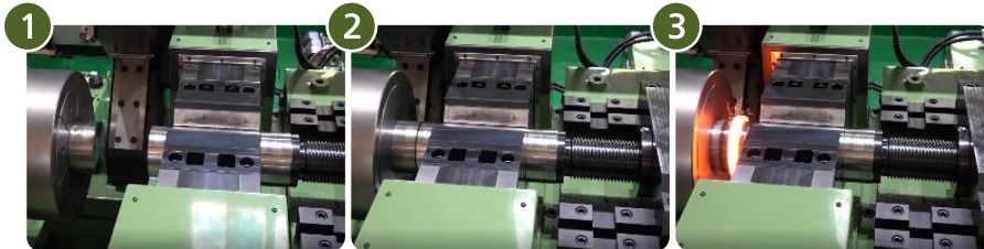
용접재료를 SPINDLE축과 TABLE축에 고정
